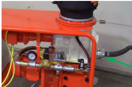
Abb. 12: Förderschlauch anschließen
