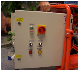
Abb. 34: Schaltschrank entnehmen
