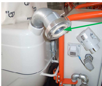
Abb. 13: Förderschlauch anschließen
