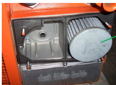
Abb. 43: Filterpatronen reinigen
