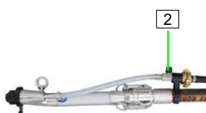
Abb. 36: Lufthahn öffnen
