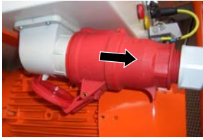
Abb. 59: Anschlusskabel entfernen
