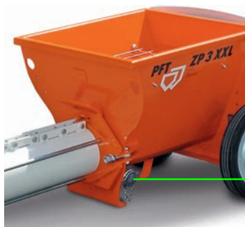
Abb. 51: Reinigungsstutzen öffnen
