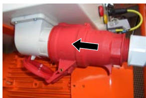
Abb. 21: Stromversorgung anschließen
