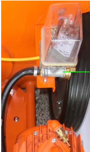
Abb. 28: Luftschlauch anschließen
