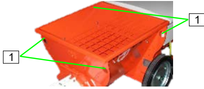
Abb. 5: Anschlagpunkte Krantransport
