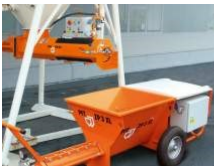
Abb. 30: ZP 3 mit Material beschicken
