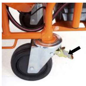
Figura 29: Bloquear la rueda con freno
