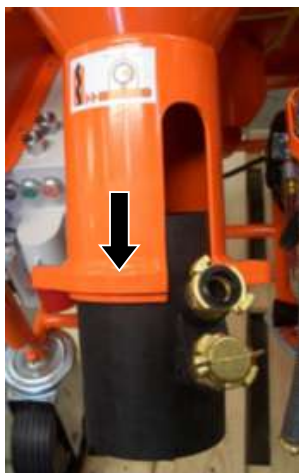
Figura 87: Limpiar la zona de mezcla de goma
