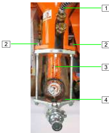
Figura 86: Desmontar la unidad de bombeo
