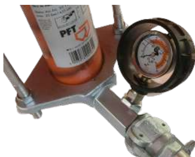
Figura 16: Manómetro de presión de mortero
