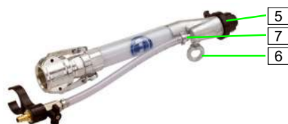
Figura 78: Limpieza de la pistola de proyección
