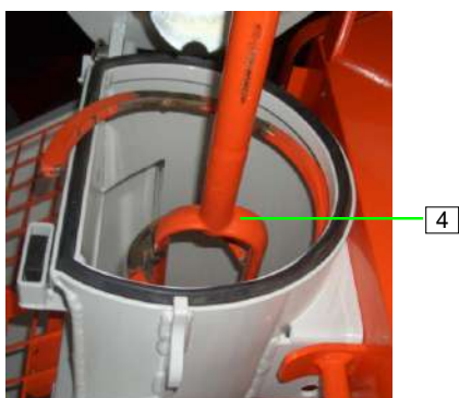
Ábra 79: A keverőcsiga eltávolítása
