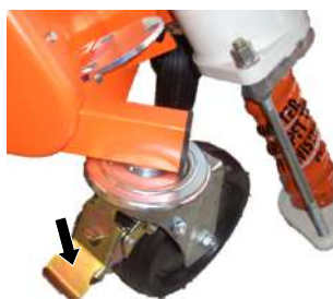
Ábra 28: A fékezhető görgő rögzítése
