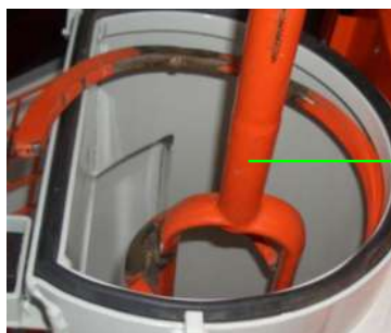
Ábra 70: A keverőcsiga eltávolítása
