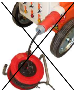
Ábra 31: A nem megengedett csatlakozási variáció illusztrációja
