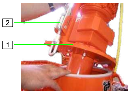
Ábra 6: A motorbillentő perem zárása
