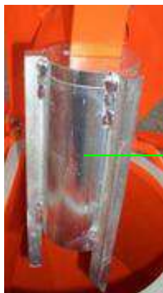
Ábra 80: A keverőcsőtisztító behelyezése
