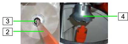
Ábra 81: A tisztítótengely illeszkedése
