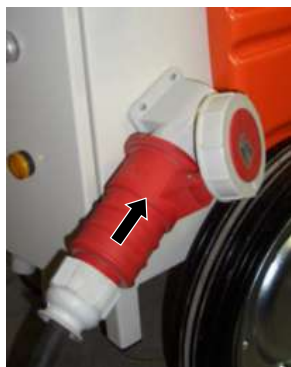
Ábra 32: Áramellátás csatlakoztatása
