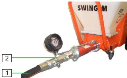
Abb. 3: Mörtelschlauch anschließen
