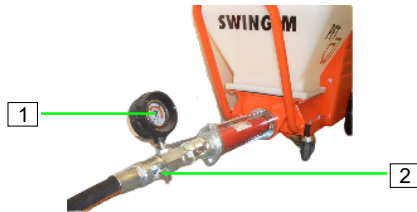
Abb. 9: Mörtelschlauch abkuppeln
