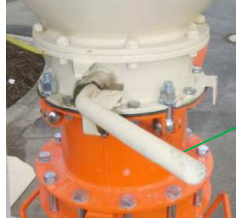
图 20: 打开料仓出口节流阀
