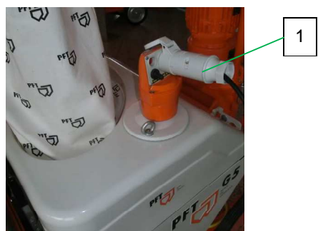
图 35: 拔出控制插头
