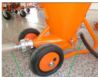
图 16: 连接软管
