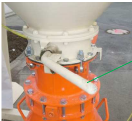
图 31: 关闭料仓出口节流阀
