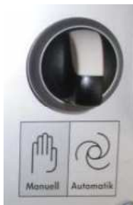
图 54: 手动模式-“0”-自动模式开关
