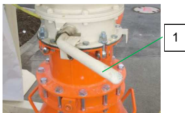
图 38: 关闭料仓出口节流阀
