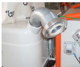
图 15: 连接输送软管
